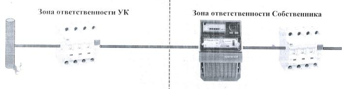
2. Границами ответственности по холодному и горячему водоснабжению и по установке полотенцесущителя являются точка первого резьбового соединения от транзитного стояка водоснабжения. Общедомовые стояки ХВС и ГВС обслуживается Управляющей компанией. Первый расположенный от стояка кран и вся водопроводная разводка внутри квартиры находится в зоне ответственности Собственника.
